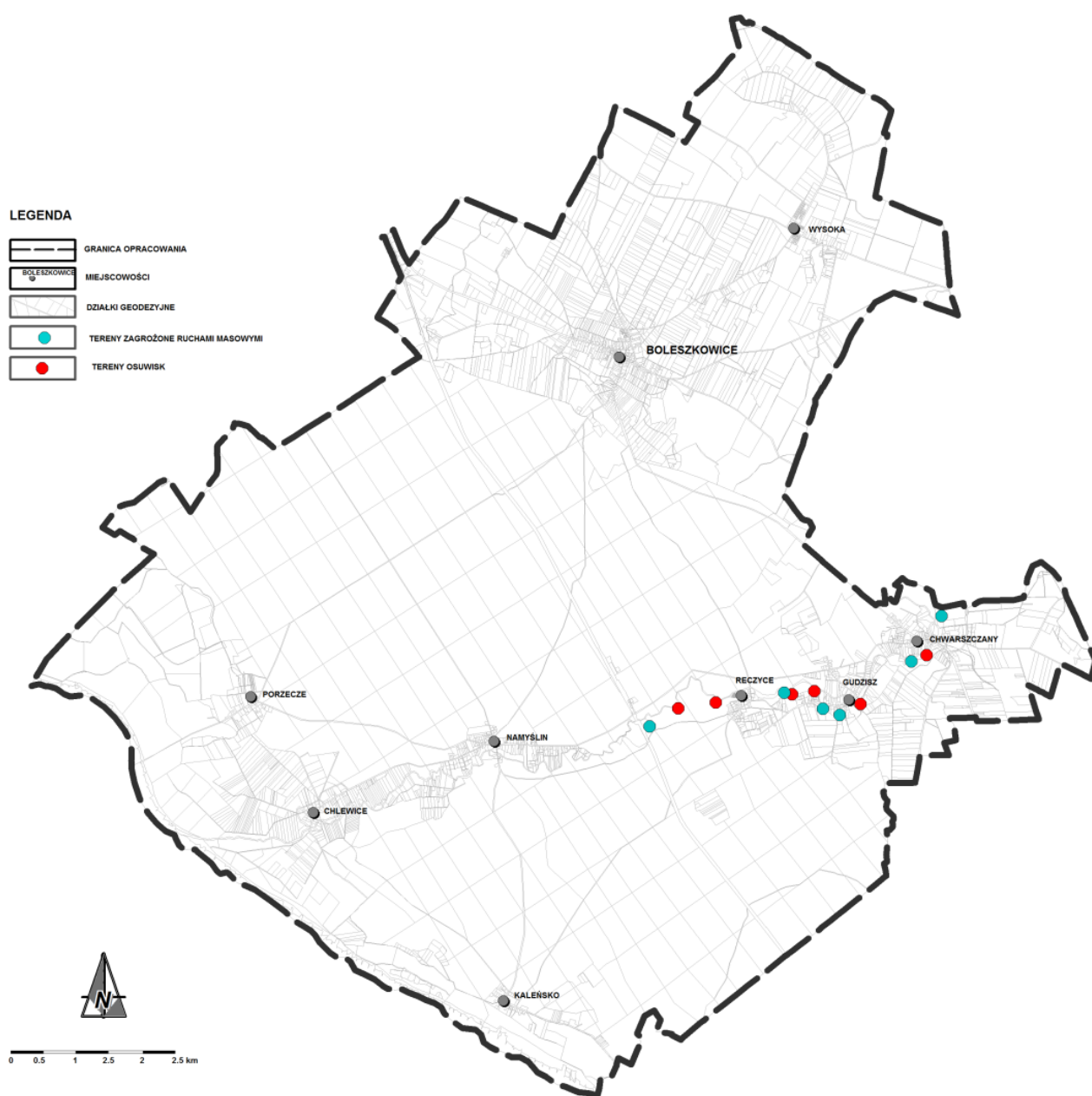
Ryc.10 Tereny osuwiskowe i zagrożone ruchami osuwiskowymi [Źródło: opracowanie własne]
