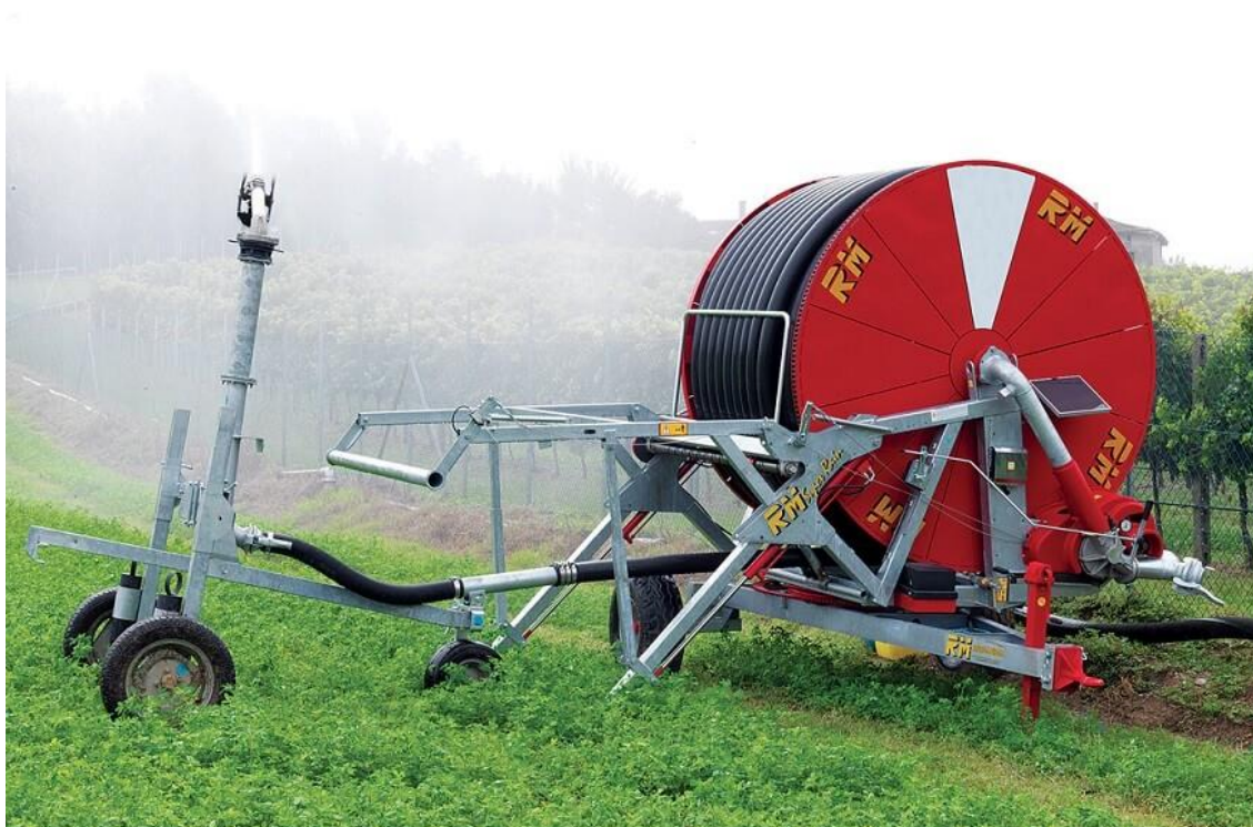
Foto. nr 2 Przykładowa deszczownia szpulowa do nawodnień ciśnieniowych – rozprowadzanie wody za pośrednictwem armatki
