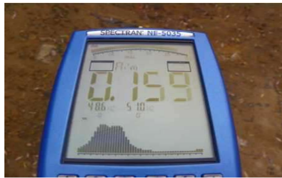
Rysunek 38 Pomiar składowej elektrycznej (na lewo) i składowej magnetycznej (na prawo) w punkcie pomiarowym zlokalizowanym w odległości ok 5m od transformatora 15kV
