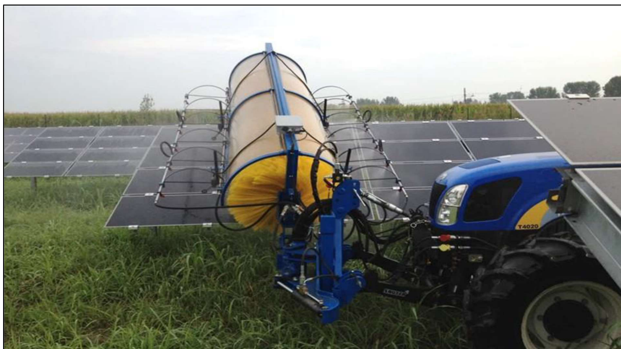
Rysunek 12 Przykładowy sposób mechanicznego mycia paneli fotowoltaicznych.
