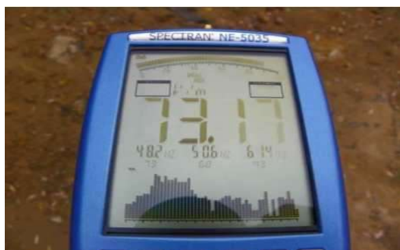
Rysunek 38 Pomiar składowej elektrycznej (na lewo) i składowej magnetycznej (na prawo) w punkcie pomiarowym zlokalizowanym w odległości ok 5m od transformatora 15kV
