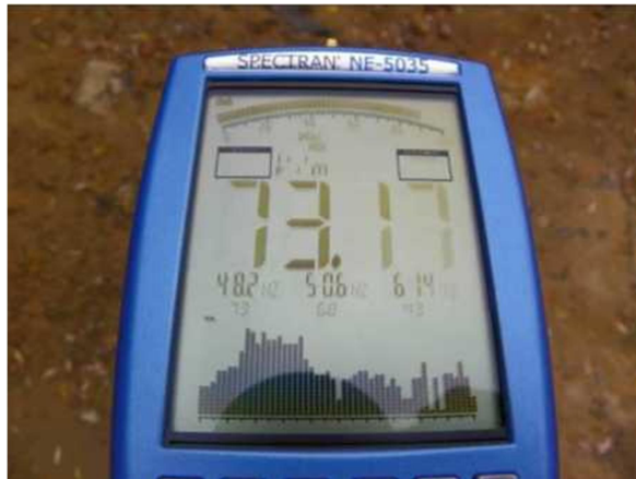
Rysunek 36. Pomiar składowej elektrycznej (na lewo) i składowej magnetycznej (na prawo) w punkcie pomiarowym zlokalizowanym w odległości ok 5m od transformatora 15kV
