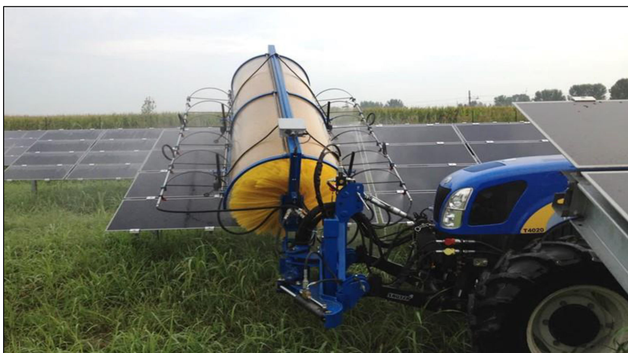
Rysunek 12. Przykładowy sposób mechanicznego mycia paneli fotowoltaicznych.
