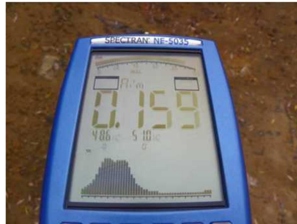
Rysunek 36. Pomiar składowej elektrycznej (na lewo) i składowej magnetycznej (na prawo) w punkcie pomiarowym zlokalizowanym w odległości ok 5m od transformatora 15kV
