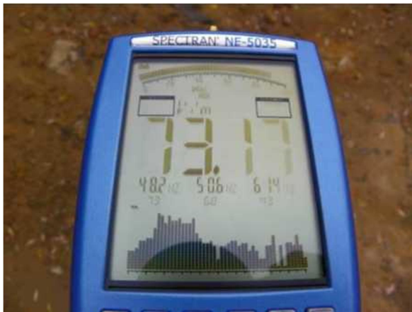
Rysunek 34. Pomiar składowej elektrycznej (na lewo) i składowej magnetycznej (na prawo) w punkcie pomiarowym zlokalizowanym w odległości ok 5m od transformatora 15kV
