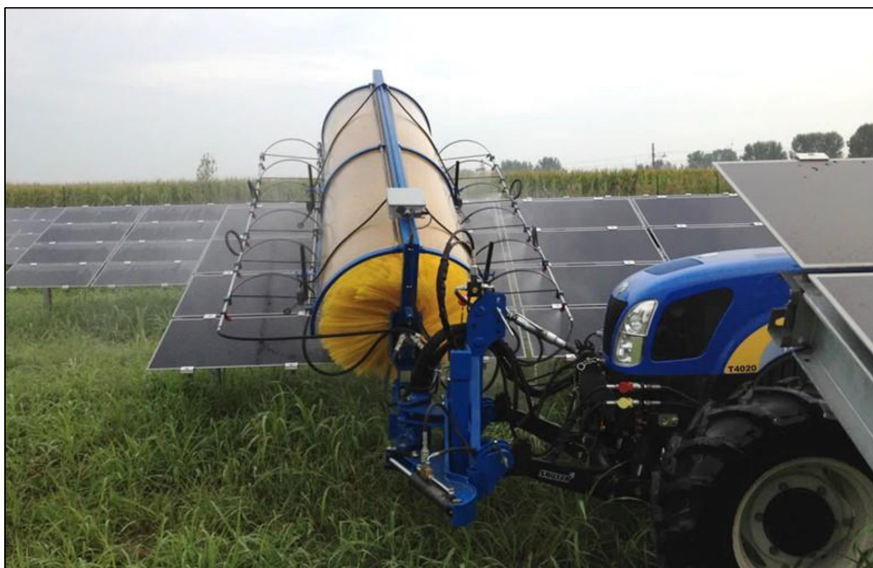
Rysunek 9. Przykładowy sposób mechanicznego mycia paneli fotowoltaicznych.
