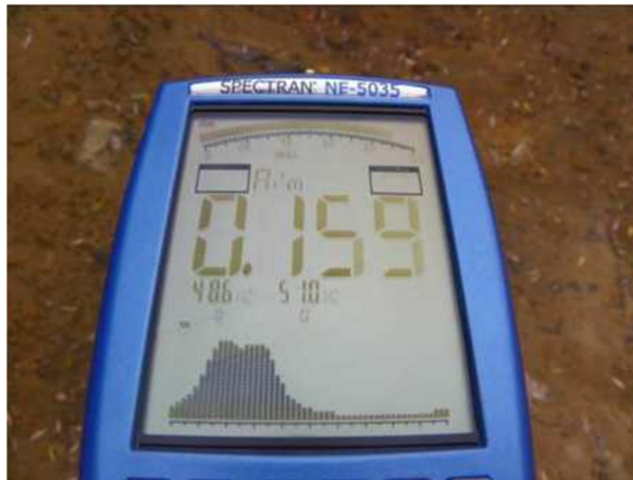
Rysunek 34. Pomiar składowej elektrycznej (na lewo) i składowej magnetycznej (na prawo) w punkcie pomiarowym zlokalizowanym w odległości ok 5m od transformatora 15kV
